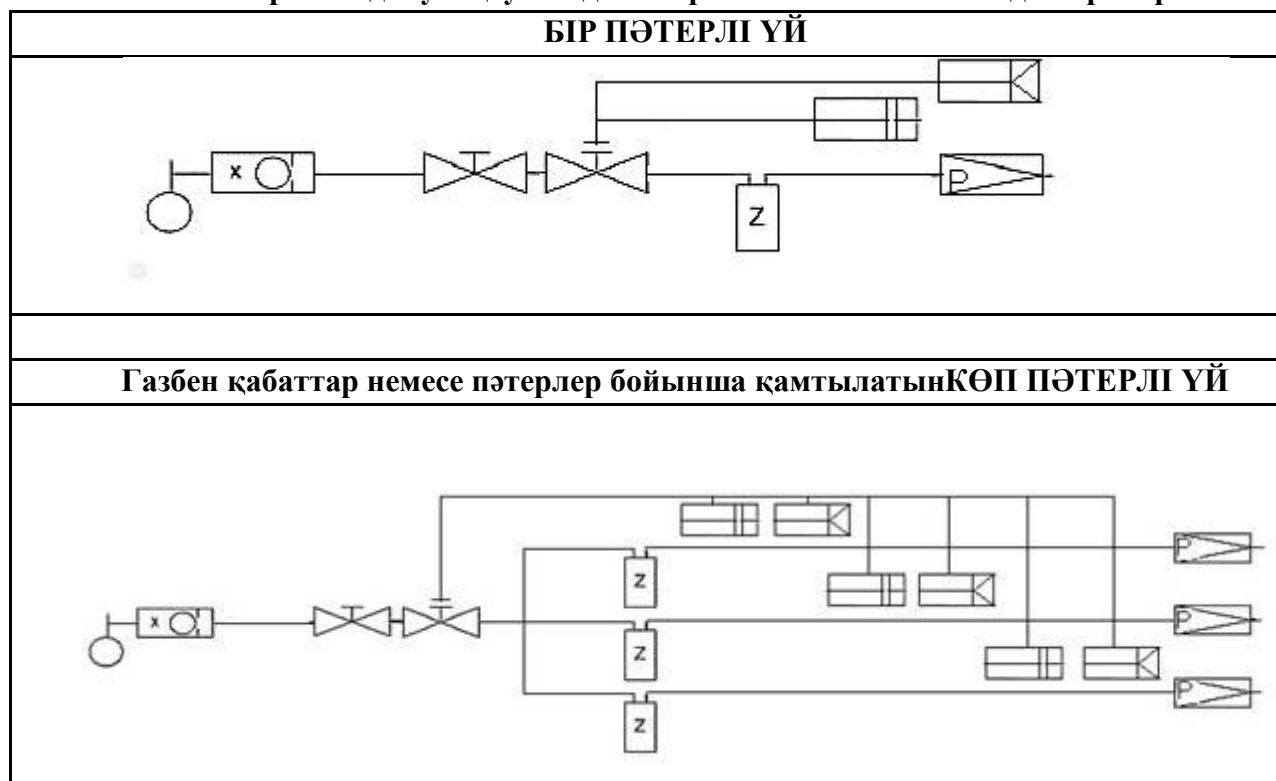
Д.1 сурет- Сыртқы газ құбырында 0,0025 МПа (250 мм су бағ)- 0,005 МПа аралығындағы қысым жағдайындағы белсенді қауіпсіздік шаралары және газ қысымын реттеу құралдары
